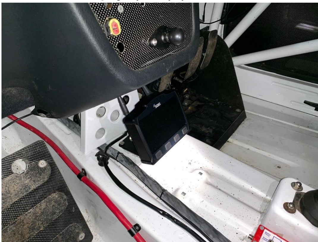
Obr. 2: Jednotka Sledovacího systému SAS namontovaná na 25mm gumový kloub a přichycená RallySafe konektorem
