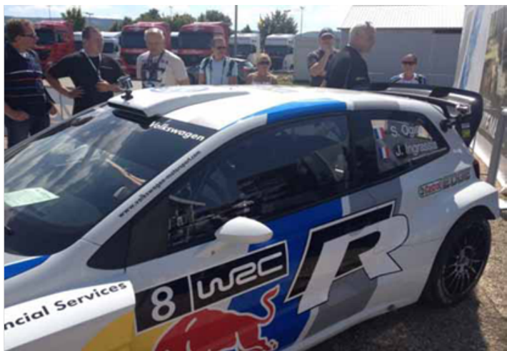
Na obrázku je nepovolená instalace externích kamer např. na střeše a C sloupku vozu
